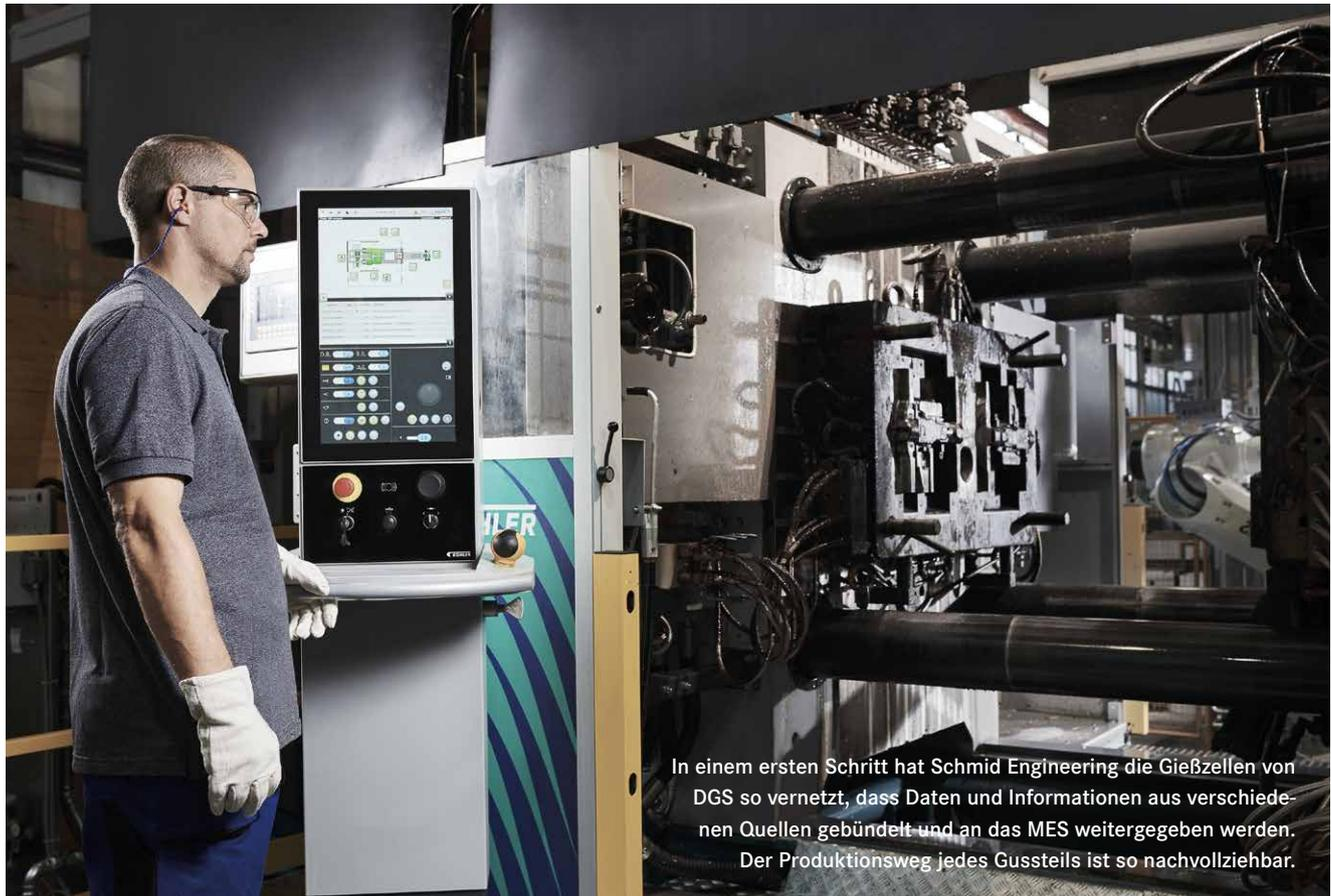
In einem ersten Schritt hat Schmid Engineering die Gießzellen von DGS so vernetzt, dass Daten und Informationen aus verschiedenen Quellen gebündelt und an das MES weitergegeben werden. Der Produktionsweg jedes Gussteils ist so nachvollziehbar.
